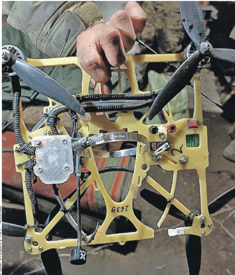
Украинский FPV-дрон, собранный на текстолитовой пластине от печатной платы. Отверстия вырезаны лазером, на плате хомут - крепление выстрела от РПГ. Стоимость такого - около 30 тысяч рублей.
