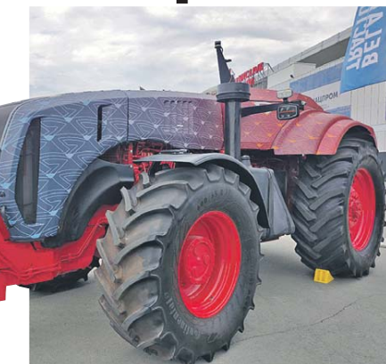
Татьяна САМОЙЛОВА Мощность трактора 359 лошадиных сил, скорость - до 40 километров в час.
