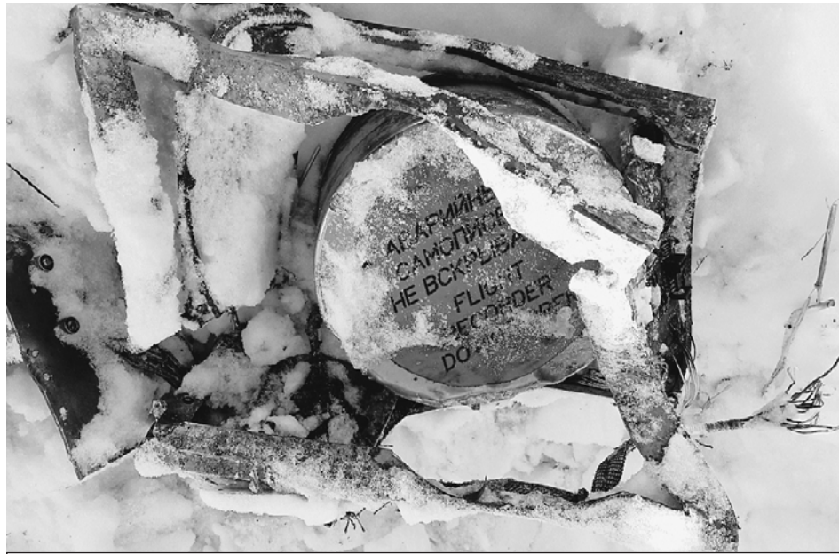
Один из самописцев, обнаруженных на месте крушения.
