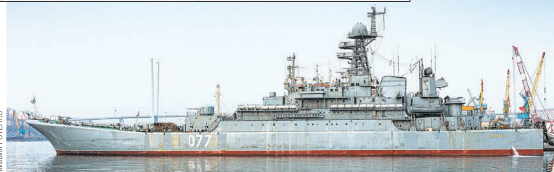
БДК «Пересвет». Большие десантные корабли «Пересвет» и «Ослябя» предназначены для переброски войск и техники морем и высадки десанта на любое необорудованное побережье.
