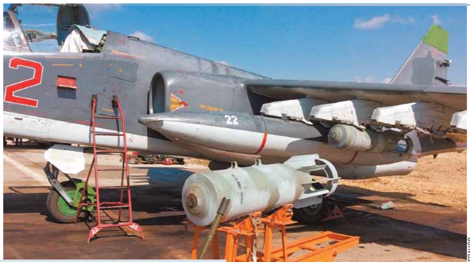
Бомбу подкатывают к самолету на специальной тележке-домкрате, поднимают ее и вставляют в пазы.
