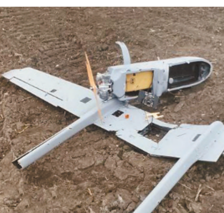
Сбитый над Джанкоем Mugin 5. Из которых поступают на территории страны в разобранном виде как детали конструктора, уже на месте собираются и дополняются местными умельцами. Дальше дела за малым — устанавливаются программное обеспечение, и все — дрон готов к выполнению задачи.
