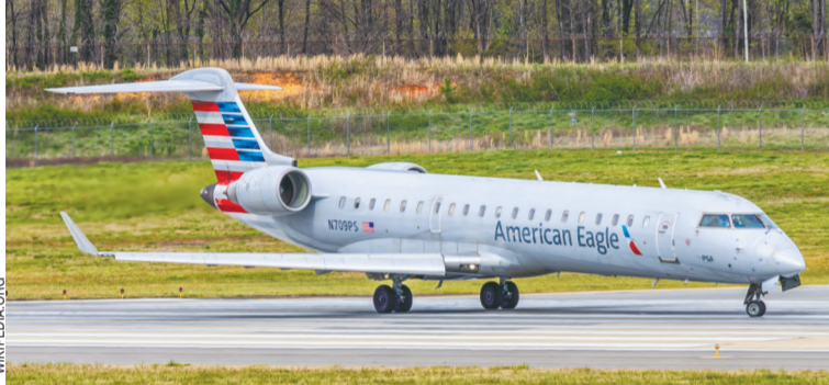
Bombardier CRJ700. Канадский пассажирский региональный лайнер. Пассажирместимость — 78 человек. Скорость — 870 км/ч. Дальность — 2700 км.
