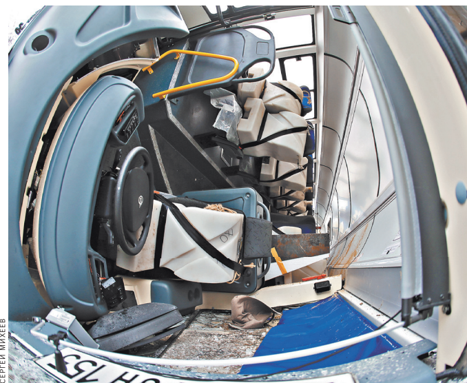
Хотя испытывают только кузов, вся начинка, включая двигатель, настоящая. На кресла усадили наполненные водой пластиковые баки — так имитируют вес. После удара крыша сместилась, вылетели боковые стекла, но большинство «пассажиров» остались в креслах — а значит, отделались испугом или легкими травмами.
