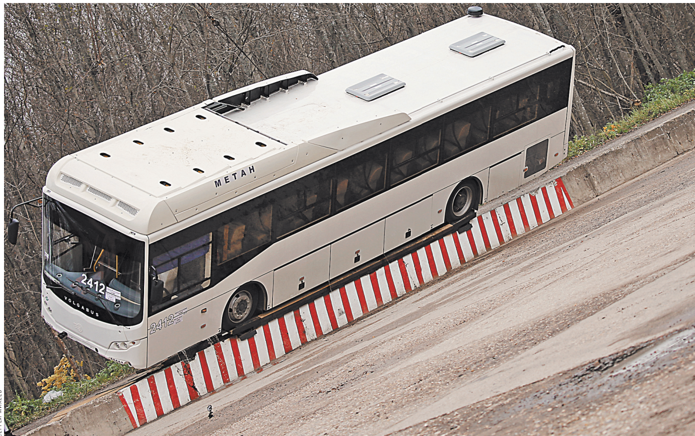
Прочность кузова нового автобуса «Волгабас Серпантин» проверили, опрокинув с высоты полметра на бетон.
