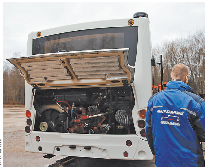
Хотя испытывают только кузов, вся начинка, включая двигатель, настоящая. На кресла усадили наполненные водой пластиковые баки — так имитируют вес. После удара крыша сместилась, вылетели боковые стекла, но большинство «пассажиров» остались в креслах — а значит, отделались испугом или легкими травмами.
