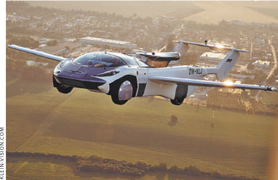
AirCar может летать со скоростью 170 километров в час на расстояние до 1000 километров.
