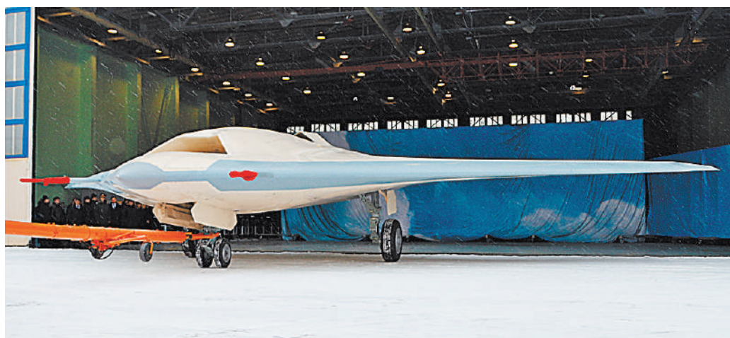
Ударный беспилотник выполнен по схеме «летающее крыло» и имеет в размахе 19 метров.
