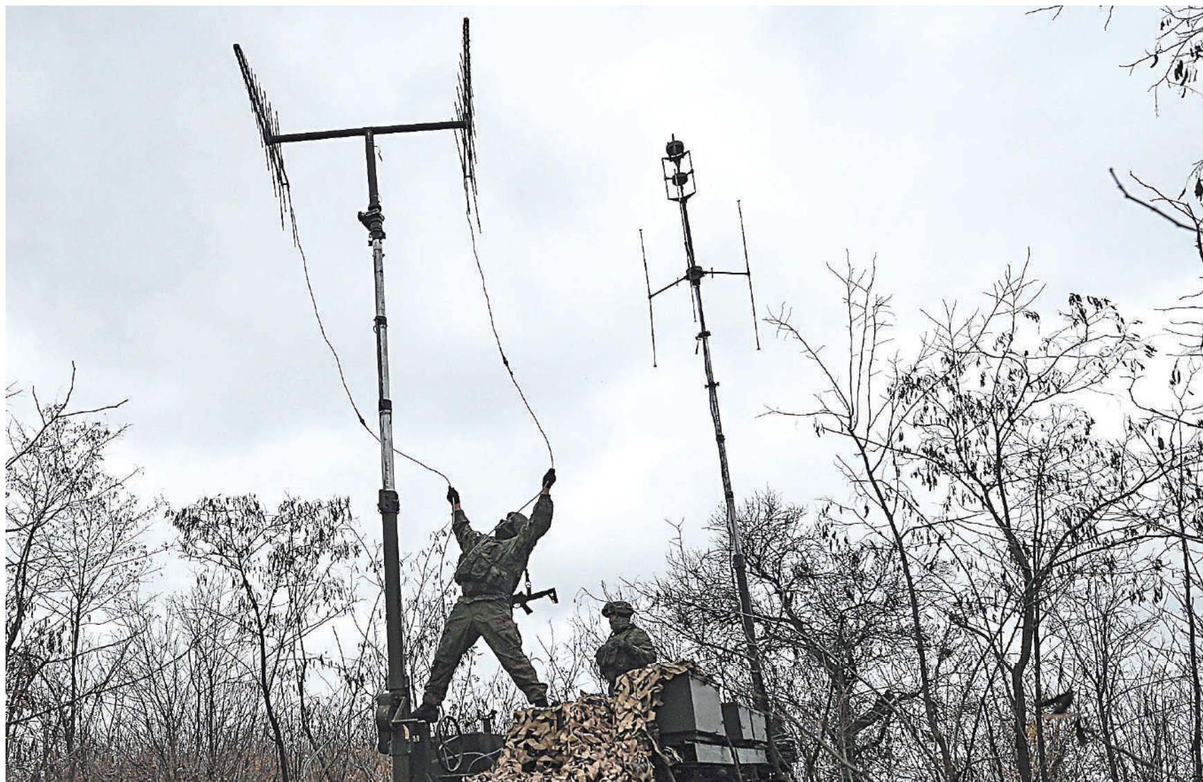
Так работают в зоне СВО наши специалисты радиоэлектронной борьбы. Они развертывают на Запорожском направлении автоматизированную станцию помех комплекса РЭБ «Борисоглебск-2».
