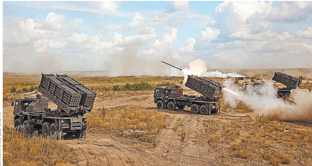
Комплекс дистанционного минирования «Земледелие» работает как реактивная система залпового огня.
