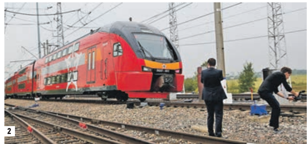
Вчера 15:00 Посол Швейцарии в России Пьер Хельг (в кресле машиниста) провел поезд KISS по экспериментальному железнодорожному кольцу в Щербинке (1) Двухэтажный четырехвагонный состав может разогнаться до скорости 160 км/ч и перевезит до 400 пассажиров (2)
