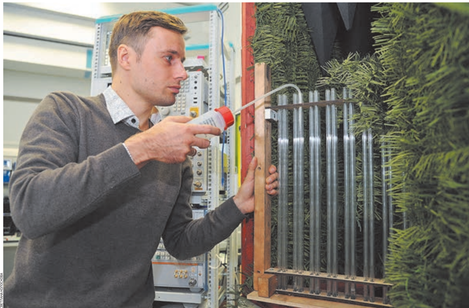
4 октября 10:40 Доцент Алексей Башарин аккуратно заполняет колбы из нового метаматериала дистиллированной водой, чтобы поставить очередной эксперимент с новым изобретением
