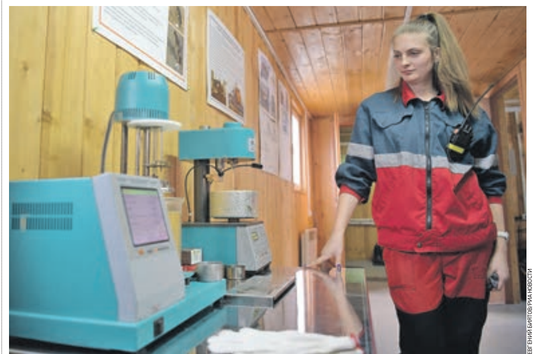
Вчера 10:24 Ведущий специалист производственной лаборатории Алла Рассказова проводит испытание битума, используемого для производства асфальта
