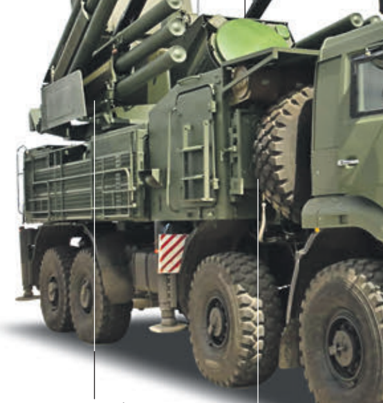
Противовоздушная оборона осуществляется автоматическими пушками и управляемыми ракетами с радиолокационным наведением с инфракрасным и радиолокационным слезением
