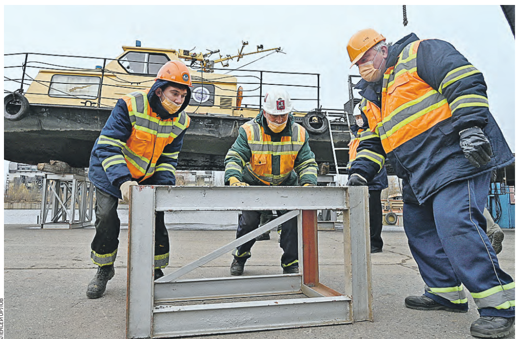
Вчера 10:10 Слева направо: речной рабочий Дмитрий Зыков, капитан рейда Алексей Полунаров и механик Андрей Селезнев устанавливают кильблок для размещения на нем судна
