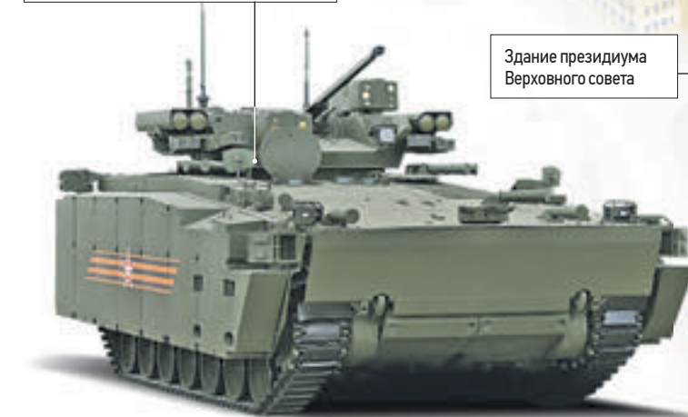
Боевая машина пехоты на платформе «Армата» Предназначена для ведения маневренных боевых действий против любого противника в составе танковых и мотострелковых подразделений в качестве основного многоцелевого боевого средства в условиях применения ядерного оружия и других видов оружия массового поражения
